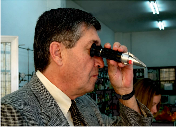
Refraktometre ile Briks ölçümü
